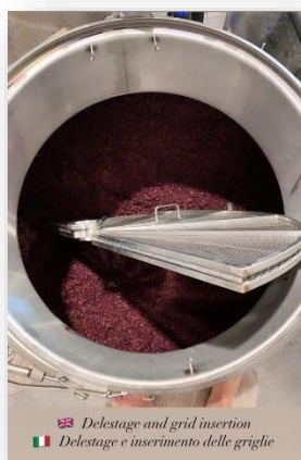
🇮🇹 Grid placement on the cap Posizionamento delle griglie sul cappello
